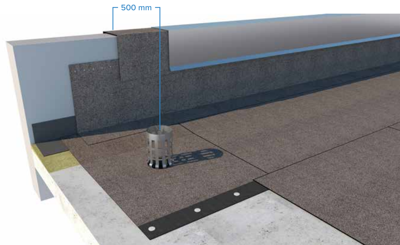
Rännal i anslutning till en vertikal yta (krön/vägg) ska utformas med motfall så att rännalscentrum bildas minst 500 mm från den vertikala ytan.
