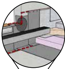
S1:4 Anslutning till vertikal yta vid tröskel
