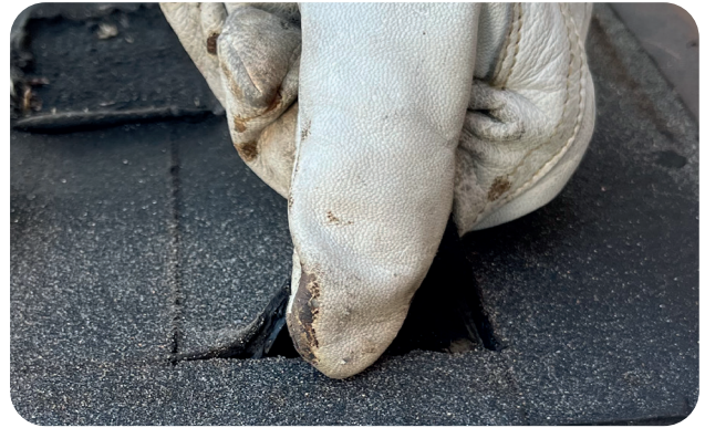
Remsan dras vinkelrät ut från underlaget.
