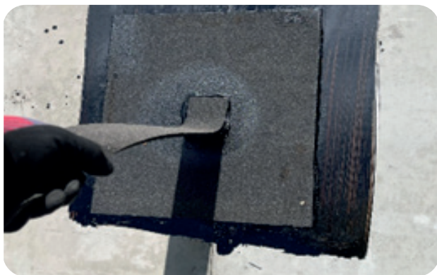
Dragprov utförs med handkraft vinkelrätt ut från underlaget. Vidhäftningsprov dokumenteras.
