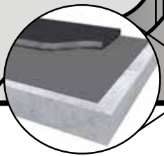
K1:2 Konstruktion Betongasfalt
