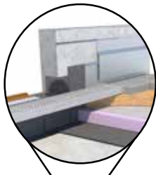
S1:4 Anslutning till vertikal yta vid tröskel
